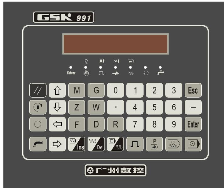
**GSK991 单轴控制器**(以下可简称“控制器”),是广州数控设备有限公司开发的又一新的数控产品。控制器采用高性能 CPU 及超大规模可编程阵列芯片构成控制核心,LED 显示,微动开关操作面板,可配套使用各种步进电机驱动器或交流伺服驱动器,通过编程可完成定位控制,及多路开关量控制,本控制器既可以作为类似带位置环的 PLC 控制器使用,也可以作为控制终端与上位控制器配套使用。
